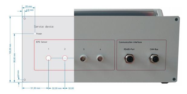
Hardwareentwicklung: Vom CAD-Konzept bis zum fertigen Systemgehäuse.
