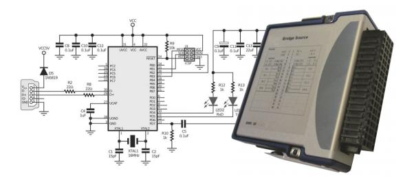
Hardwareentwicklung: Vom Schaltplan bis zum fertigen cDAQ-/ cRIO-Modul
